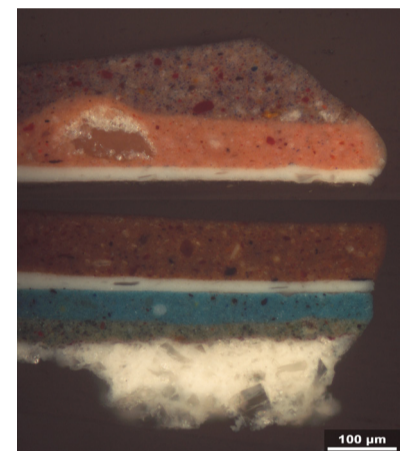
Der zweiteilige Anschliff eines Bildschichtpakets zu „Die hohen Nischen“ von 1930/1942 zeigt zwei dünne, weisse Zwischenschichten mit einzelnen grösseren, transparenten Partikeln (Auflichtmikroskop Leitz DMRB, Hellfeld-Beleuchtung mit gekreuzten Polarisatoren).
